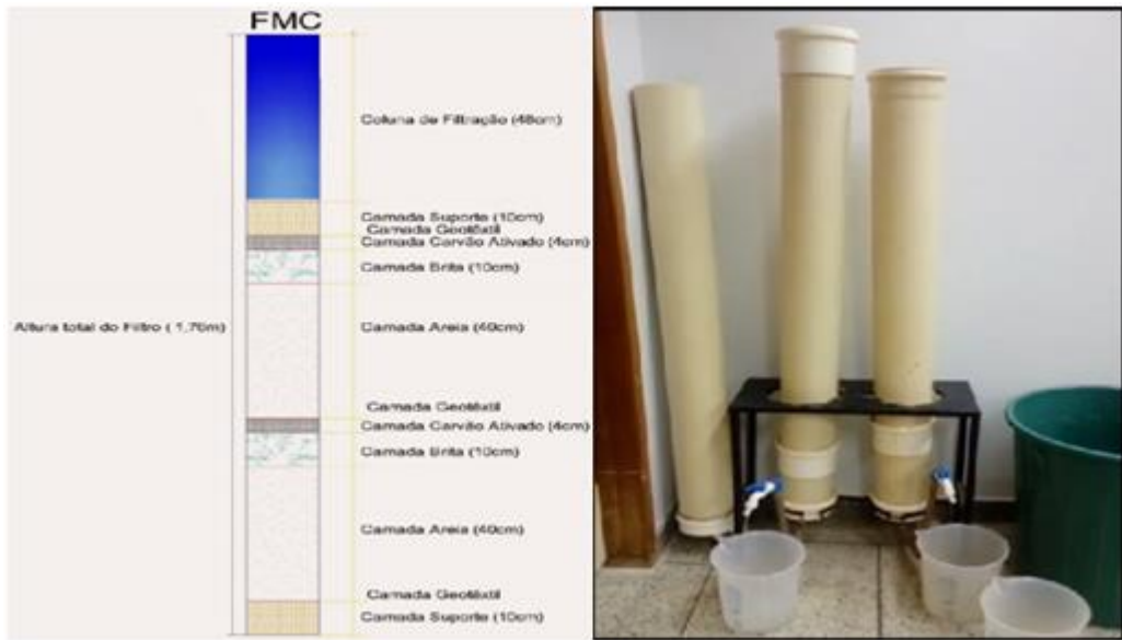
Figura 01 – Esquema do filtro/ filtros de PVC
